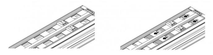
Regolare la serranda con un cacciavite da sotto il diffusore montato.
